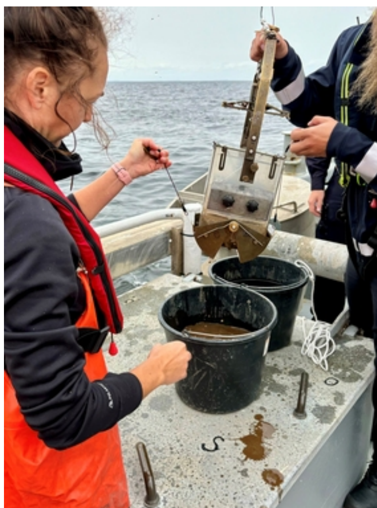
Protagning av bottendjur - bottenhugg med Ekmanhämtare på över 70 meters djup vid station Tärnan i Vänern i augusti. Foto: SLU.
